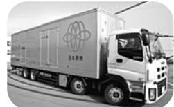
この電源車は、発電に必要な機器一式をトラックに搭載しており、常に敷地内に配備されています。そして、もしもの時にはすぐに現場へ駆けつけ、仮設の発電所となって速やかに工場に必要な電気を送ることができます。
